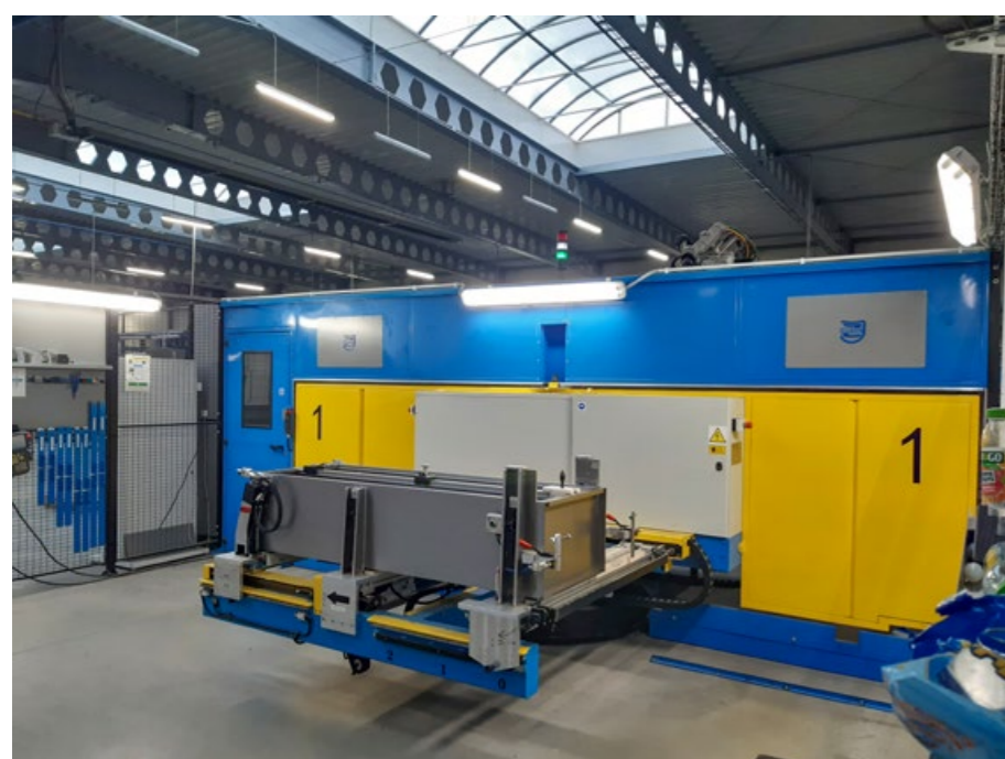
PROTOTYP LINII ZAUTOMATYZOWANEGO STANOWISKA MONTAŻU
