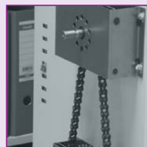
Solidny mechanizm korbowy – duże przełożenie, łatwość przesuwu.
